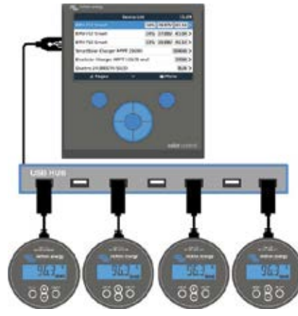
Maksimum dört adet BMV Color Control'e doğrudan bağlanabilir. Merkezi izleme için daha fazla BMV bir USB Merkezine bağlanabilir.
